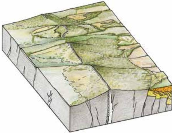
Arriba: bloque diagrama geológico de la disposición de un filón de cuarzo verticalizado en un macizo granítico, cuya tenacidad y resistencia a la erosión hace que quede en el relieve como una cresta o alineación de cerros.
